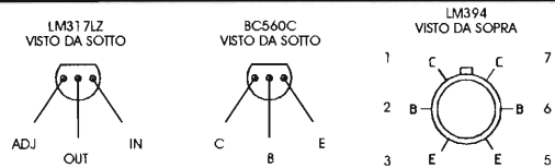
figura 6 - Piedinatura integrato e transistor.
